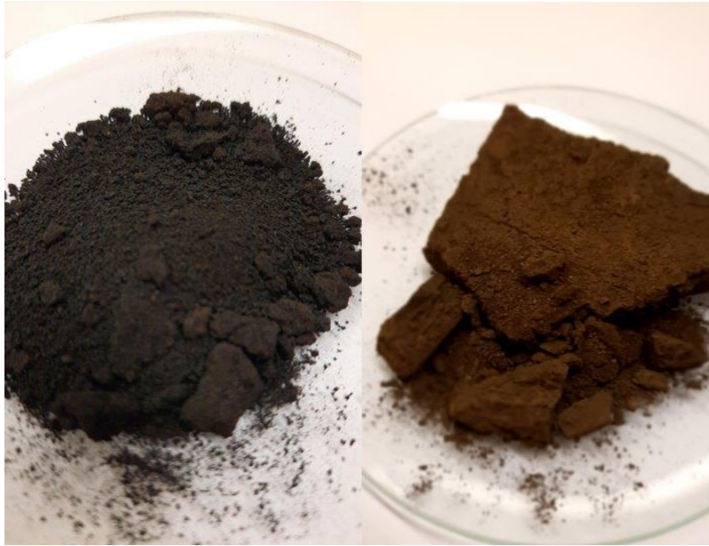
Kuva 16 Perunan solumassan ja rehujakeen sekoituksesta valmistettu märkähiili vasemmalla ja mädätejäännöksestä valmistettu märkähiili oikealla. Elintarvikenäytteiden toimitus: Satafood kehittämissyhdystys ry, mädätejäännös: Gasum Oy.
