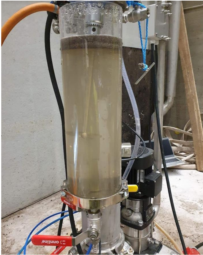
Kuva 2 Tertiäärikäsittelyyn käytetty flotaatiolaitteisto
