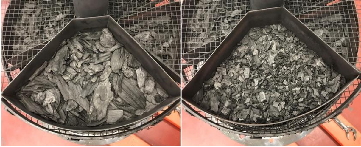
Kuva 10. Vasemmassa kuvassa suuremman partikkelikokoon biohiili, oikealla murskattu biohiili.
