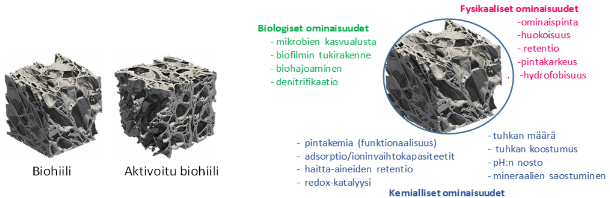
Kuva 6. Männyn kuoresta valmistetun biohiilen huokoisuutta voidaan lisätä aktivoinnilla /Siipola ym., 2018, Mohanty ym. 2018/ ja siten muokata biohiilen fysikaalisia, kemiallisia ja biologisia käyttöominaisuuksia.
