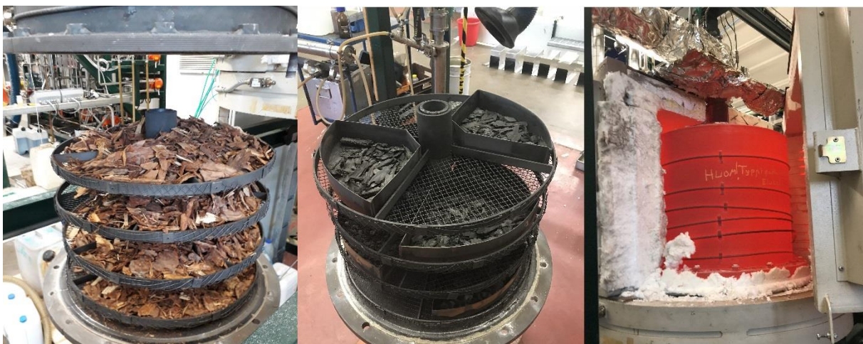
Kuva 9. VTT:n hidaspyrolyysiuuni: vasemman puoleisissa kuvissa uunin sisälle asetettava näytteenpidike, oikean puoleisessa kuvassa jäähtymään avattu uuni aktivointikäsittelyn jälkeen.
