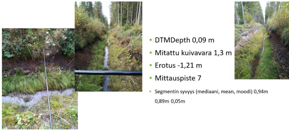
Kuva 11. Havainnekuva kohteesta, jossa oli huomattavan iso ero (-1.21 m) laserkeilatun (DTM) ja maastossa mitatun kuivavaran välillä. Segmentin keskimääräiset arviot (mediaani ja keskiarvo) arvioivat paremmin ojasyvyyden kyseisellä kohteella, mutta segmentin moodin arvio oli epätarkka.
