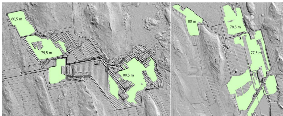
Kuva 2. Kampinneen ja Ohraneen alueet, joille voidaan sijoittaa korkeaa vedenpintaa vaativia jatkokäyttömuotoja: soistamista, kosteikkoja tai kosteikkoviljelyä. Kuvaan on merkitty, mille korkeudelle vedenpinta on enimmillään nostettavissa kullakin loholla ilman, että ympäröivät alueet ovat vaarassa vettyä. Taustalla laserkeilattu kuva © MML.
