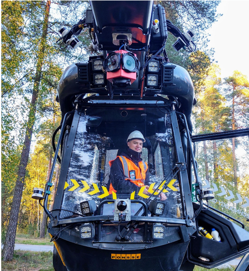
Kuva 1. Kuvassa näkyy osa syksyn 2024 koetyössä mukana olleista laserkeilaussensoreista ylhäällä puomin molemmien puolin sekä ohjaamon sivuilla ja edessä keskellä. Lisäksi ohjaamon yläpuolella keskellä puomia näkyy 360-kamera. Näiden lisäksi puomin päällä oli useita GNSS-paikannuslaitteita sekä radiopaikannuksen vastaanotin. (Kuva: H. Hyyti 2024)
