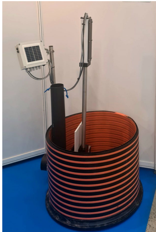
Kuva 1. Tilaisuuksissa oli esillä Oulun yliopiston tutkijoiden rakentama demokaivo, jonka säätöventtiiliä pystyi ohjaamaan mobiililaitteella.
