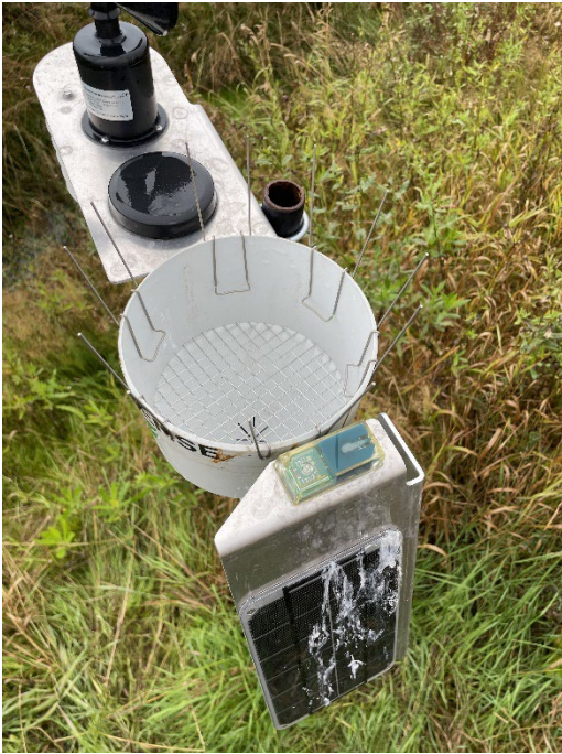
Kuva 5. Kesällä 2023 linnut sotkivat Nivalassa Cordulus-sääasemaa. Elokuun lopulla laitteeseen saatiin karkotimet.
