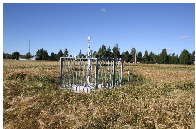
Kuva 2. Vaisalan WX Beacon sääasema Kannuksessa.
