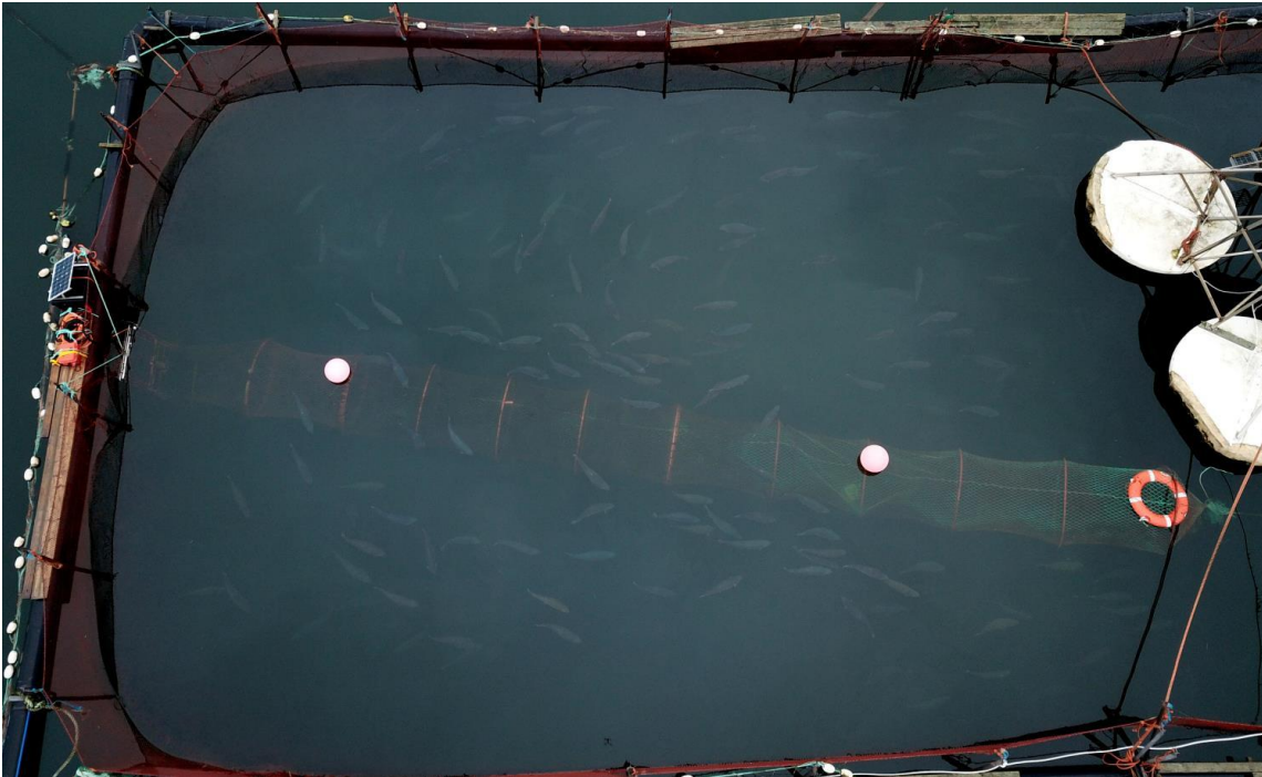
Kuva 11. Hylkeitä vangitseva laite kalanviljelylaitokseen asennettuna.
