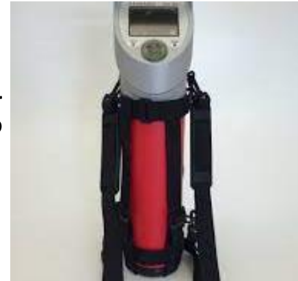
GEORADIS Gamma Ray Spectrometer
