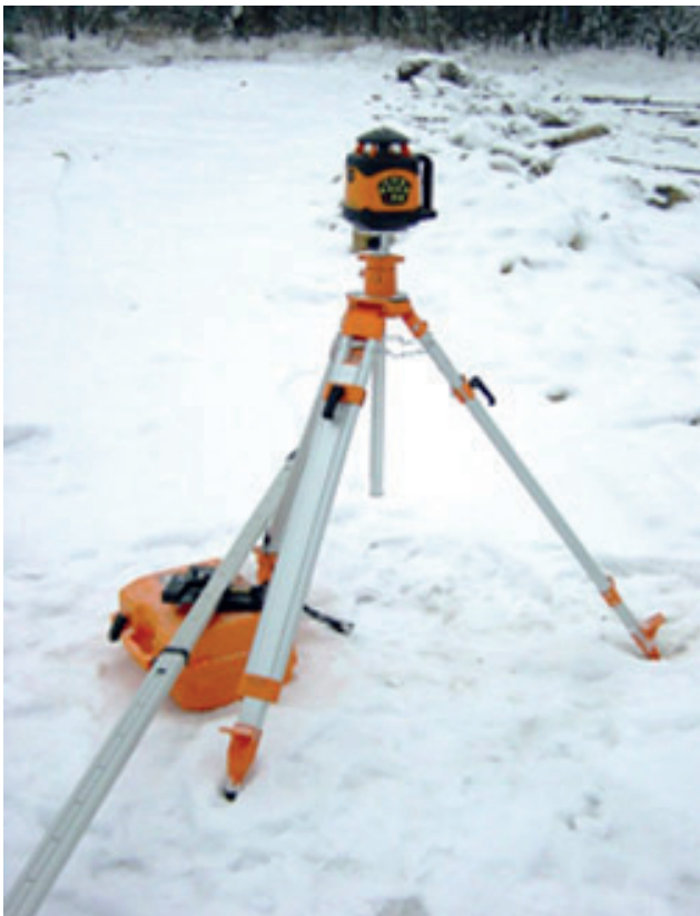
Kuva 40. Koskien kynnyksalueiden rakenteiden sijoitus mitataan joskus tarkasti tasolaaserilla tai vaa'itsemalla.
