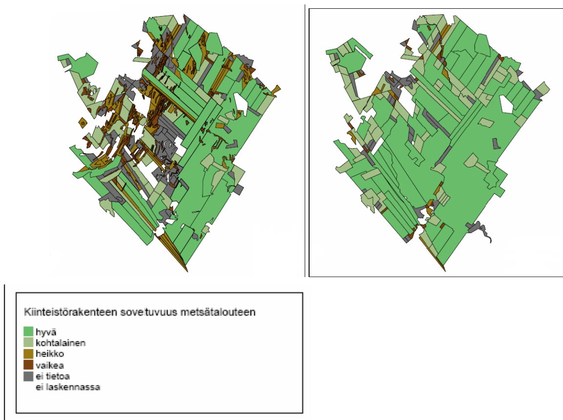
Kuva 4. Siikajoen Merikylän alue ja kiinteistörajat ennen ja jälkeen uusjaon. Kuvassa on esitetty väreillä metsälöiden soveltuvuus metsätalouden harjoittamiseen ns MEKIRA-sovellusohjelmalla laskettuna (kts. Luku 5)
