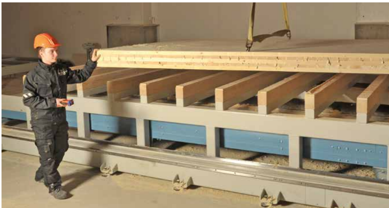
Bild 1. CrossLam i Kuhmo inledde tillverkningen av inhemska CLT-skivor (Cross Laminated Timber) av massiv trä i december 2014. (Foto: CrossLam)
